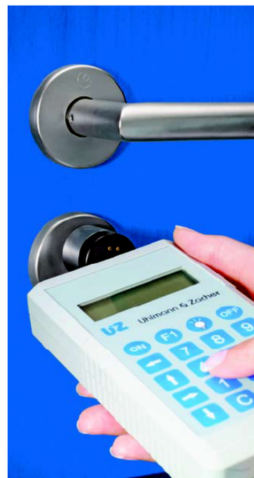
Bild 4: Ereignisprotokolle können leicht mit Hilfe des Service-Gerätes erstellt werden.
