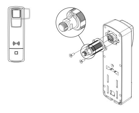
Geräte mit Produktionsdatum vor Juni 2023 Für Geräte mit älterem Produktionsdatum wird die Drehrichtung des Betätigungshebels durch die Position der Schraube am Befestigungsgewinde festgelegt.
