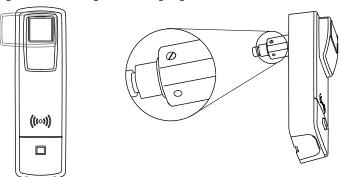
Öffnung durch Drehung des Betätigungshebels nach rechts:
