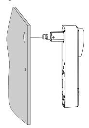
Schrankschloss mit Hilfe von Befestigungsschraube (maximales Drehmoment 2 Nm) und Befestigungsmutter (maximales Drehmoment 5 Nm) fixieren.
