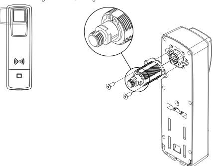
Öffnung durch Drehung des Betätigungshebels nach rechts Die Nut zeigt in dieser Stellung nach oben.
