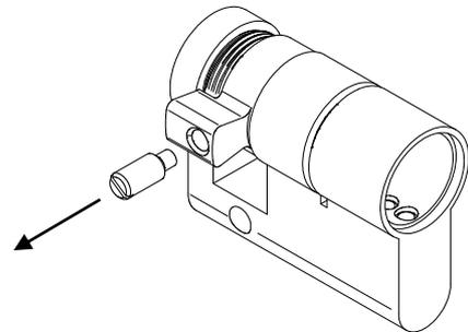
**1. Schraube der Schließnase lösen.**
